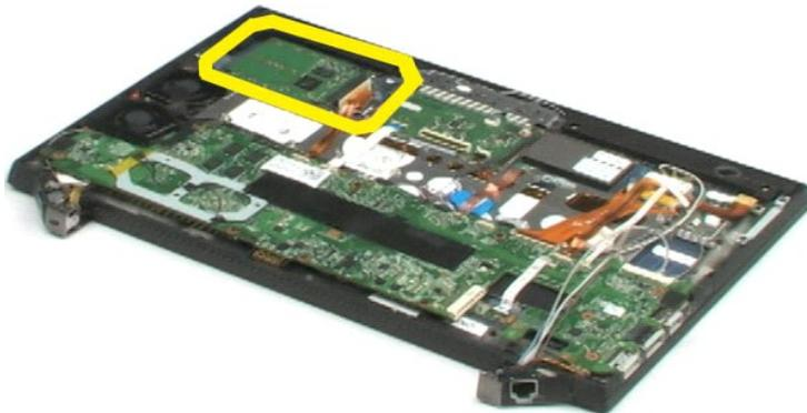
5. Trennen Sie das Festplattenkabel vom Anschluss auf der Systemplatine.
